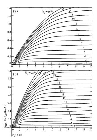
Figure 7 Normalized grounded-source characteristics. (a) 500Å device, L=0.35 mil,  $L_{\rm eff}=0.18$  mil  $(R_{\rm D}W/L_{\rm eff}=110\Omega,$   $R_{\rm S}W/L_{\rm eff}=75\Omega)$ ; (b) 1000Å device, L=0.5 mil,  $L_{\rm eff}=0.29$  mil  $(R_{\rm D}W/L_{\rm eff}=400\Omega,$   $R_{\rm S}W/L_{\rm eff}=60\Omega)$ .
