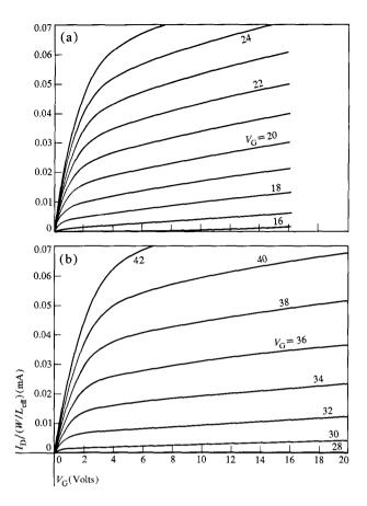
Figure 9 Characteristics of parasitic thick-oxide devices. (a) 6000Å, L=0.35 mil  $(L_{\rm eff}=0.19$  mil,  $R_{\rm D}W/L_{\rm eff}=800\Omega$ ,  $R_{\rm S}W/L_{\rm eff}=8k\Omega$ ); (b) 10,000Å, L=0.50 mil  $(L_{\rm eff}=0.29$  mil,  $R_{\rm D}W/L_{\rm eff}=350\Omega$ ,  $R_{\rm S}W/L_{\rm eff}=4.1k\Omega$ ).
