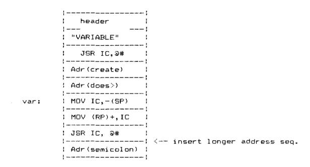
Fig. 3.13 Dictionary Entry for <u>VARIABLE</u>.
