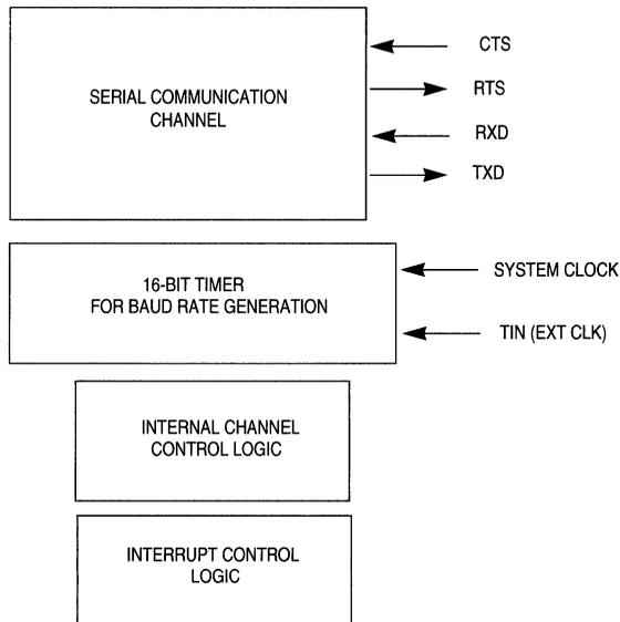
**Figure 12-1. UART Block Diagram**
