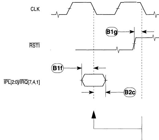
MODE SELECTS ARE REGISTERED ON THE PREVIOUS FALLING CLK EDGE BEFORE THE CYCLE IN WHICH RSTI IS RECOGNIZED AS BEING NEGATED.
